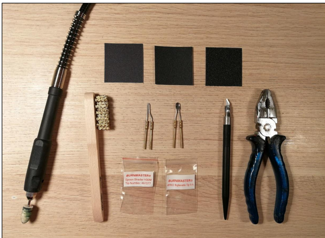
Slika 8: Pripomočki za oblikovanje in poliranje konic
